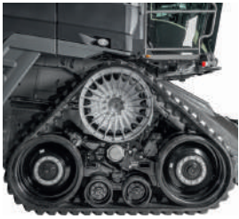
Гусеничное шасси TrakRide минимизирует давление на грунт.
